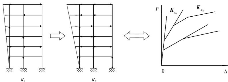
图 3.2 非线性构形状态转移过程示意图
